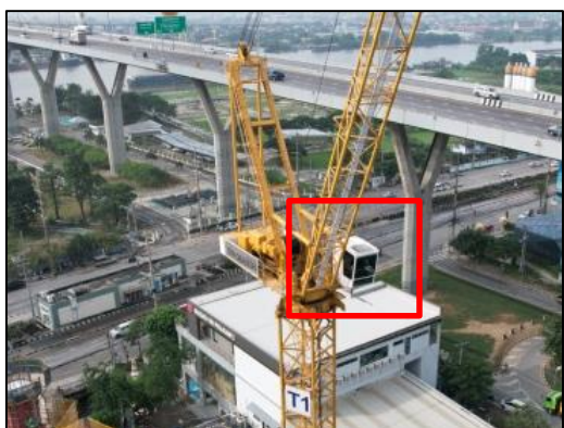
ภาพที่ 107 กระจกปิดมิดชิดที่ Cabin ของ Tower Crane
